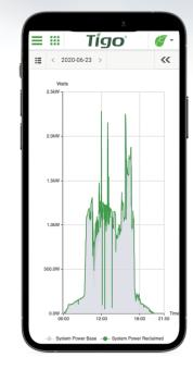
Die Funktion "Reclaimed Energy" von Tigo zeigt die von den Tigo-Optimierern gewonnene Energiemenge an (alle 2 Minuten des Tages in Grün angezeigt)
