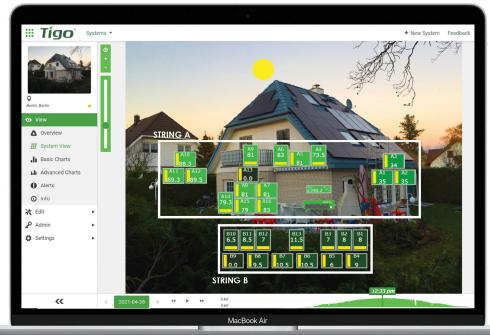
Ohne Optimierung würde der Wechselrichter einen niedrigeren Betriebspunkt für den String wählen und die unbeschatteten Module würden weniger beitragen, als sie unter den Standortbedingungen produzieren können. Stattdessen bleiben die Module mit der besten Leistung am vom Wechselrichter eingestellten maximalen Leistungspunkt und die Optimierer passen ihre Leistung an, um das beste Ergebnis zu erzielen.
